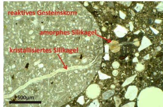
Abbildung 1: Gelbildung sichtbar gemacht im Dünnschliff.
